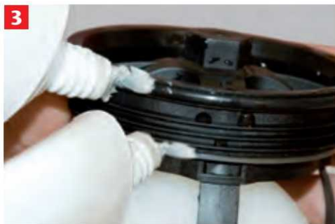
Dichtungen an der Rückstaeinheit einfetten
